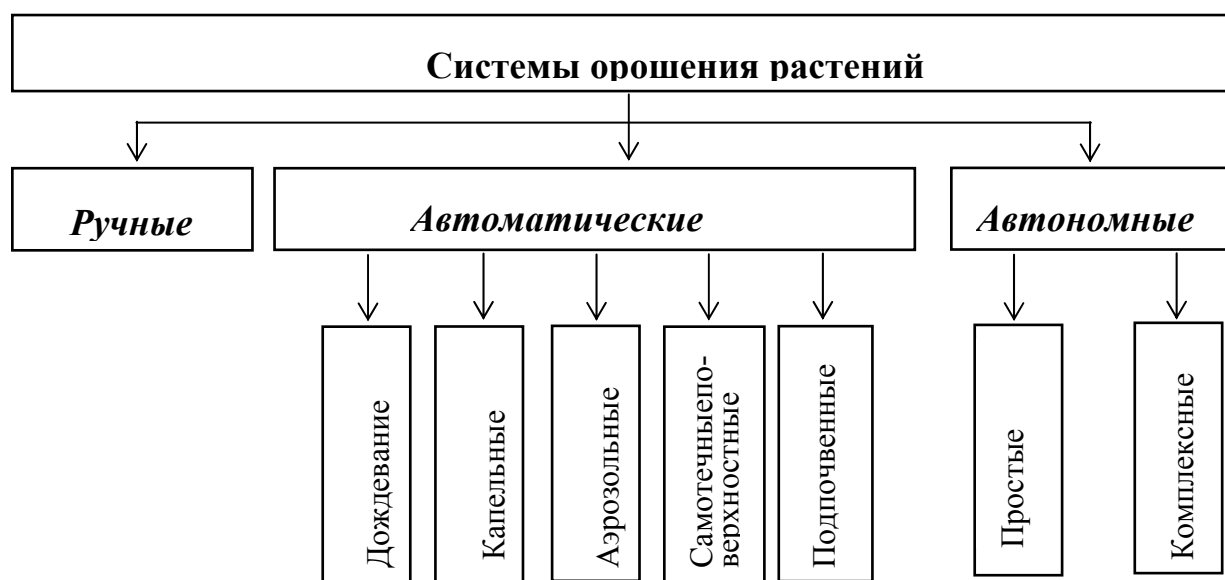
Рис. Классификация устройств для орошения растений по принципу действия
